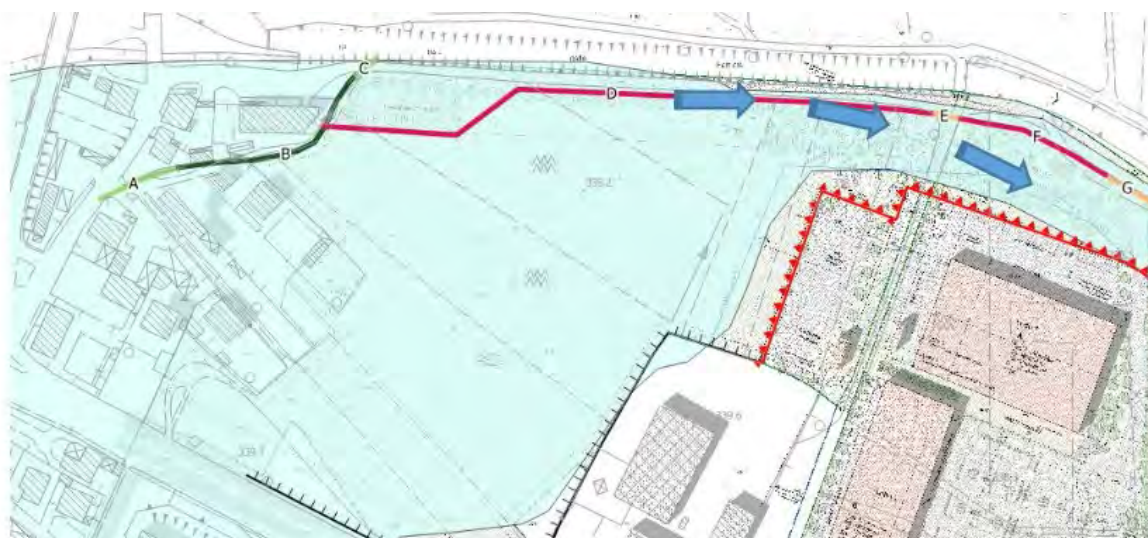
Figura 1 - Tratti rossi (D, E, F e G): canale a cielo aperto il terra che sottopassa la viabilità di progetto mediante scatolari (tratti E e G). Tratti verdi: canale a cielo aperto del canale minore che raccoglie le acque all'incrocio tra Via dei Testa e Corso Dora (loc. Pertusera) (B). I tratti A e C sono intubati.
